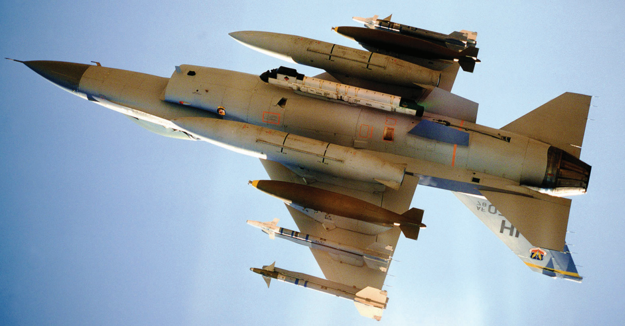
Slika 12: Američki avion F-16 Fighting Falcon, s dvije rakete zrak-zrak Sidewinder, jednom bombom od 2.000 kilograma (izvor: www.britannica.com/technology/rocket-and-missile-system/ , pristupljeno 17.07.2020. godine)
